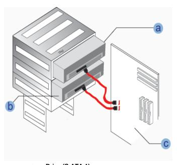
a : Drive (S-ATA 1)b : Drive (S-ATA 2)c : Mainboard
